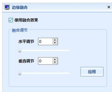
如下图所示, 使用边缘融合可以消除因拼接单元之间的物理缝隙, 而形成的拼接后的图形变形不对位。调节水平框架尺寸和上下框架尺寸以达到比较好的效果。例如: 边框的值根据屏的物理边框来设置。例: LTI460HA03 的边框是 10MM, 两个屏的就是 20MM 在此处设置的值就应该为 20, 边缘融合是适用于整块大屏一起调节。
