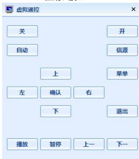
升级程序可用虚拟遥控来操作,先按菜单 按钮,大屏会出现遥控菜单,在按右键,大屏遥控菜单里有软件升级这一项,把升级程序解压后拷进U 盘插上U 盘,选择软件升级项根据大屏的提示进行升级操作。
